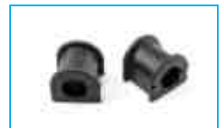
1425034 GOMA VARILLA ESTABILIZADORA DELANTERA (2)
