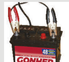
POLARIDAD INVERTIDA Recargar la batería con polaridad invertida e instalar de nuevo, causa daños al sistema eléctrico.
