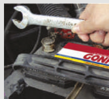
CORTO PROVOCADO Por unir los postes con algún objeto metálico para comprobar carga o que los postes hagan contacto con el cofre.
